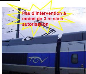
Schématisme de la zone dangereuse "électrique"
